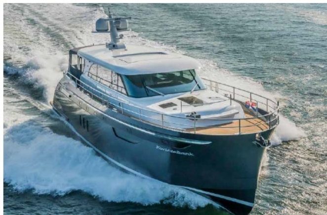
DE STEELER JACHTEN HEBBEN EEN DOOR STUDIO DELTA ONTWIKKELD GLOOPTIJSLEISER ONDERWATERSCHEP VOOR EEN LITTLE WAFF, ZOALS DE HIERAF GEBEELDE ALUMINIUM STEELER 61'S PERFORMANCE, DIE EEN SNELHEID VAN 34 KNOPEN KAN BEREIKEN.
