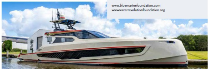
DE VANQUISH 80 SF IS EEN 24,4 METER LANGE 'CHASE BOAT' VOOR HET SPORTVISHACHT SKYFALL DAT DOOR HEESSEN WORDT GEBOUWD. TWEE C24 CATERPILLAR EN TWEE C20V24 DIEZELMOTOREN VAN 480 PK MAKEN HET ACHT SURFDEKEL. HET HAART ALS TOPTIMER DAN 51 KNOPEN. STUDIO DELTA WASTE ONDERMEER EEN PETESTEP ONDERWATERSCHIPTOET OM DIT MOGELIJK TE MAKEN. Foto: Coy Yacht
