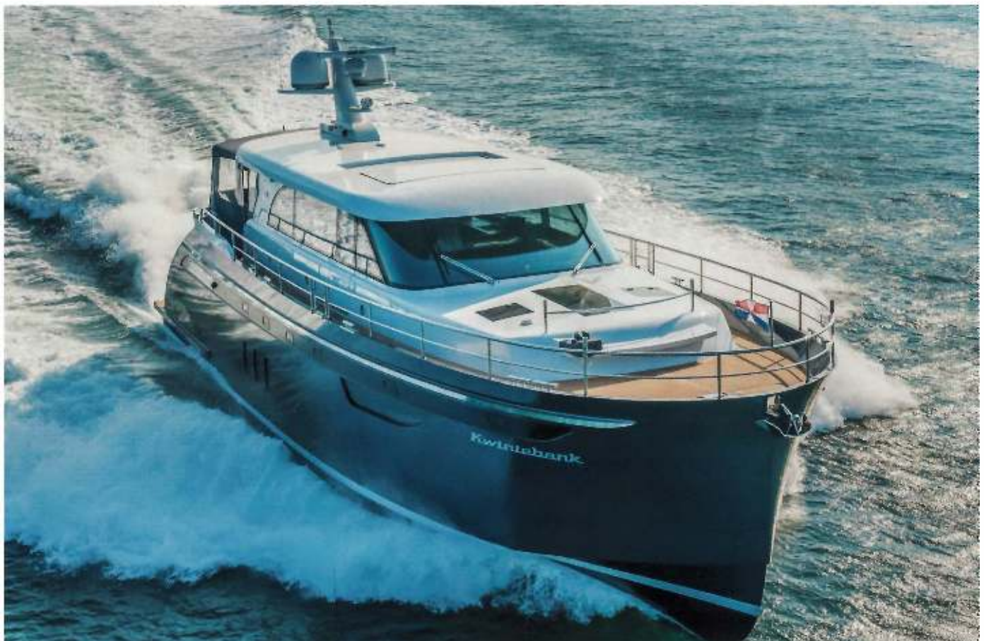
DE STEELER JACHTEN HEBBEN EEN DOOR STUDIO DELTA ONTWIKKELD GEOPTIMALISEERD ONDERWATERSCHIP VOOR EEN VLOTTE VAART, ZOALS DE HIER AFGEBEEDE ALUMINIUM STEELER 61 S PERFORMANCE, DIE EEN SNELHEID VAN 24 KNOPEN KAN BEREIKEN.
