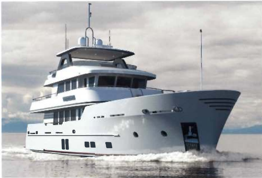
HET DRAAIT NIET ALLEEN OM SNELLE SCHEPEN; STUDIO DELTA REKENDE OOK AAN DEZE 26 METER STALEN WATERVERPLAATSER MET BULBSTEVEN. HET TRAWLERJACHT WORDT GEBOUWD DOOR MARTENS MARINE IN SINGAPORE EN WERD ONTWERPEN DOOR GUIDO DE GROOT.
