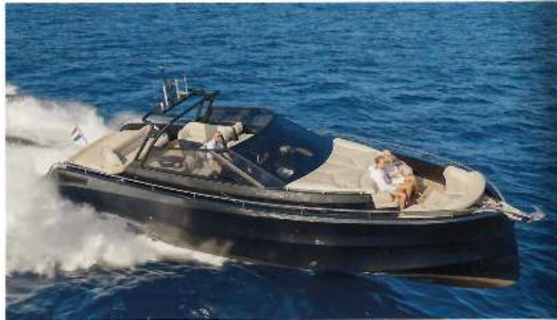
DE BRONSON 50 VAN STEELER YACHTS. HET ALUMINIUM MOTORJACHT VAN BIJNA 15 METER LENGTE HAALT MET TWEE VOLVO PENTA D8 IPS-800 MOTOREN EEN TOP VAN 37 KNOPEN. DE WERF ONTWIKKELDE SAMEN MET VRIPACK HET IN- EN EXTERIEUR; STUDIO DELTA WAS DE NAVAL ARCHITECT.
